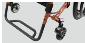
No.21 パイプ ¥24,000 軽量で強く、シンプルな構造です。 滑りにくいローレット加工を施し ています。
