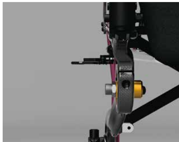
アンダーフレームの車軸受部を 10mm 内側にインセット。 車いすの全幅が抑えられ、操作性や狭い場所での取り回しが向上します。
