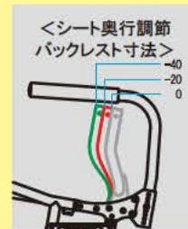
**G L1: シート奥行 [mm] & シート奥行調節バックレスト寸法 [mm]**
