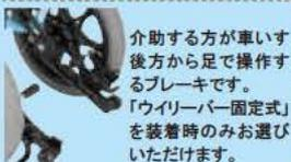
介助する方が車いす後方から足で操作するブレーキです。「ウイリーバー固定式」を装着時のお選びいただけます。
