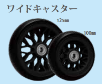
WCR5(アルミコアワイドキャスター) 125mm 100mm 削り出しアルミコアによる美しい外観のワイドキャスターホイール(幅35mm)です。溝に落ちにくく、サスペンションを備えたような乗り心地が特長です。2ピース構造により、キャスターゴムが摩耗した際はゴムのみ交換ができます。ワイドタイプのキャスターフォークに適合。
